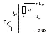
Wenn der Lüfter abgeschaltet ist, hängt der Zustand des Ausgangssignals U<sub>A</sub> von der Kundenapplikation ab. When the fan is powered off, the ouput signal U<sub>A</sub> depends on the customer's application.
