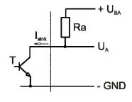
Wenn der Lüfter abgeschaltet ist, hängt der Zustand des Ausgangssignals U<sub>A</sub> von der Kundenapplikation ab. When the fan is powered off, the output signal U<sub>A</sub> depends on the customer's application.
