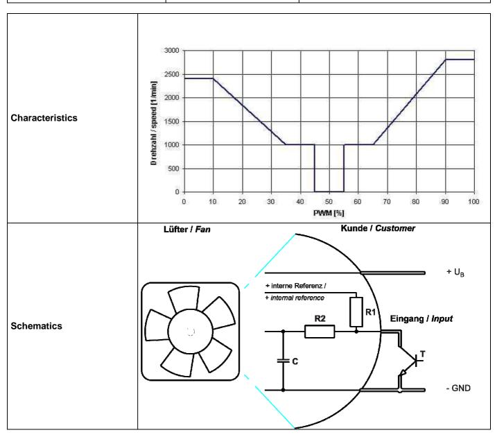
Lüfter mit Drehrichtungsumkehr. 0% - 45% PWM über Stege blasend, 55% - 100% über Stege saugend.
