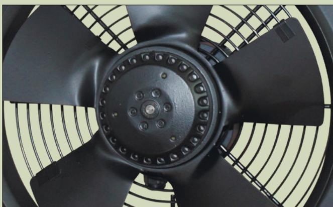
Оборудован электродвигателем с внешним ротором, имеет крыльчатку, изготовленную из металла с черным порошковым покрытием и с установленными серповидными лопастями, которые динамически сбалансированы в двух плоскостях для лучшего шумоподавления
